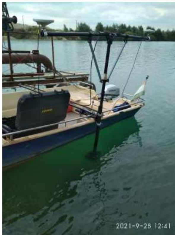
A mederfelmérésre összeállított rendszer
