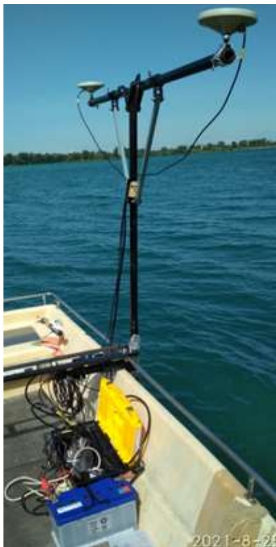
A mederfelmérésre összeállított rendszer
