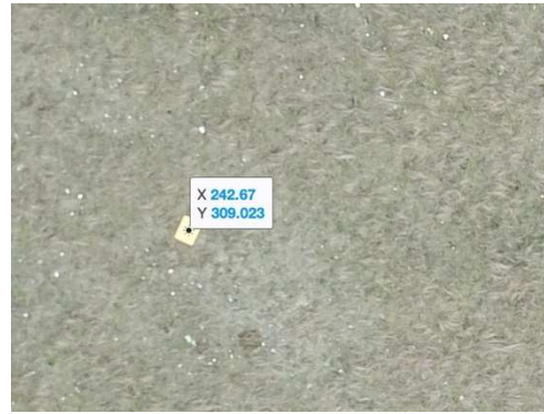
4. ábra. A pontjel centroidjának számított koordinátái a képkordináta-rendszerben.
